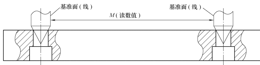
图 C.4 初始值设定为“零”值时的示值检查读数示意图(圆锥测头)
